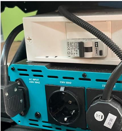
Abbildung 4: 230V-Sicherung ausgeschaltet
